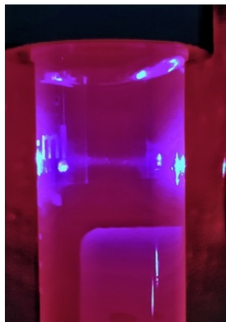
Abb. 29 TE der homogenisierten PC nach 24 h rühren und Zentrifugation.
